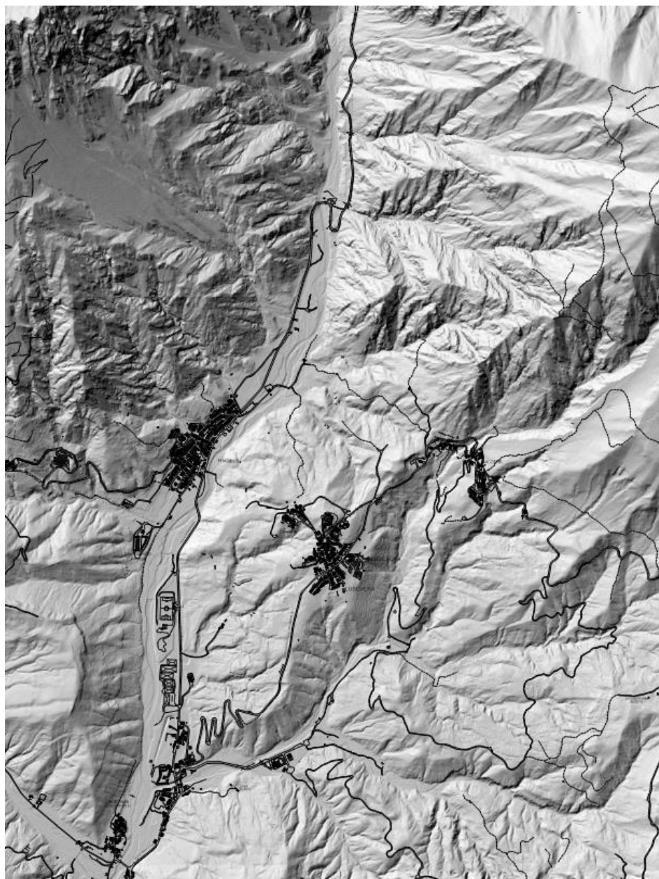
Figura 3 – Modello digitale del terreno elaborato da dati Lidar
